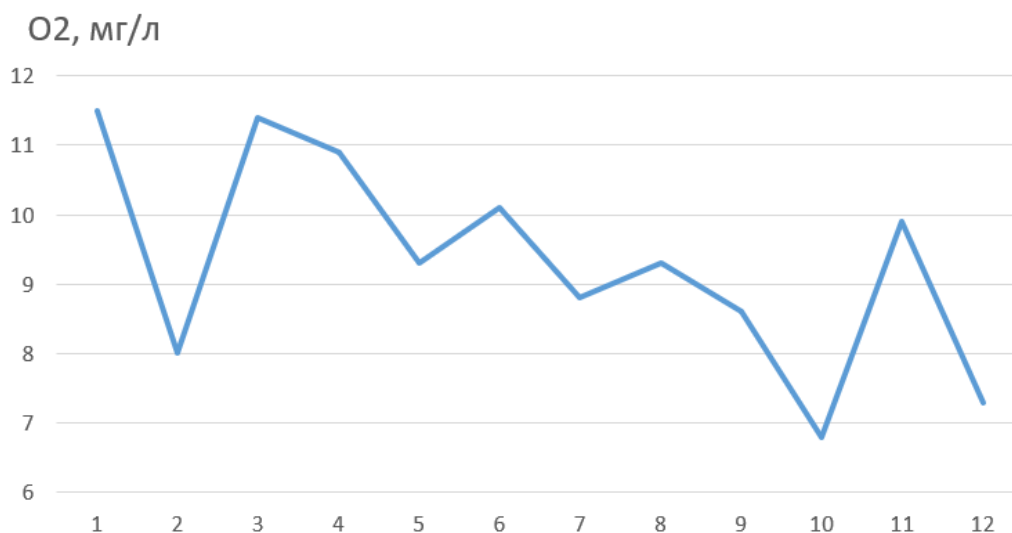
Рис. 5. Концентрация кислорода в р. Золотоструйка в 12 створах на протяжении 400 метров. Створы 2 и 10 соответствуют участкам до плотин, 3 и 11 – после.
