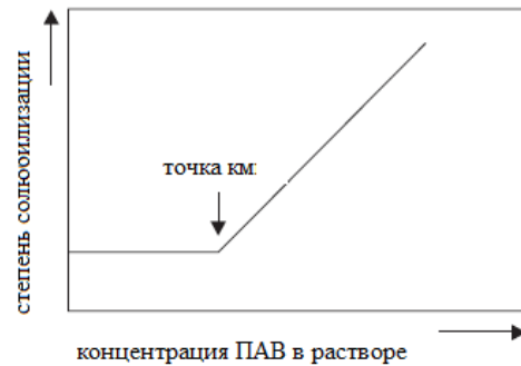
Рис. 3. Зависимость процессов солубилизации от концентрации ПАВ, точка км – точка критического мицеллообразования (Ying et al., 2006).
