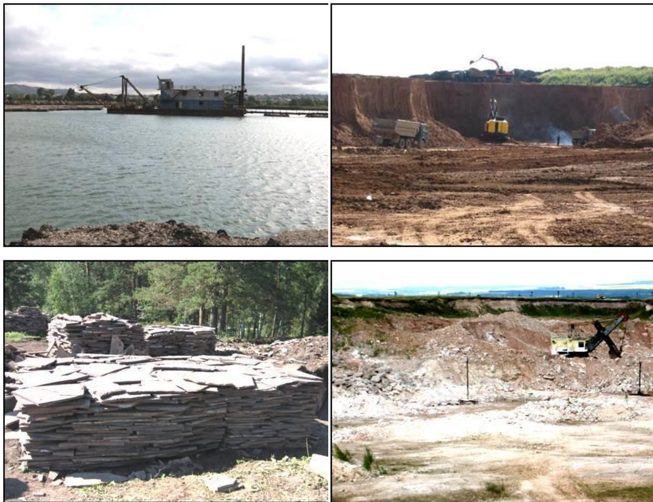
Рис. 2.1. Технологии добычи ОПИ: песка, глины, строительного камня и гипса
